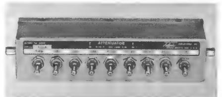
Hochfrequenz-Spannungsteiler für  $82,5\text{ dB}$  Gesamtdämpfung von Telonic Industries, Inc., USA. Die gewünschte Gesamtdämpfung wird durch Kombinieren der einzelnen Schalter eingestellt
