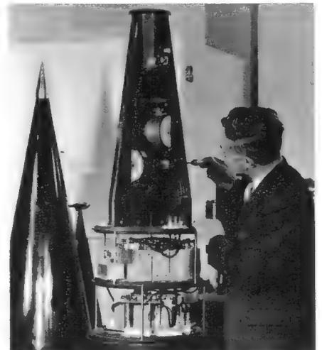
Bild 15. Das Bild zeigt das Abgleichen einer Forschungsrakete für die obere Atmosphäre und Ionosphäre in der Radio Research Station, Slough, Buckinghamshire
