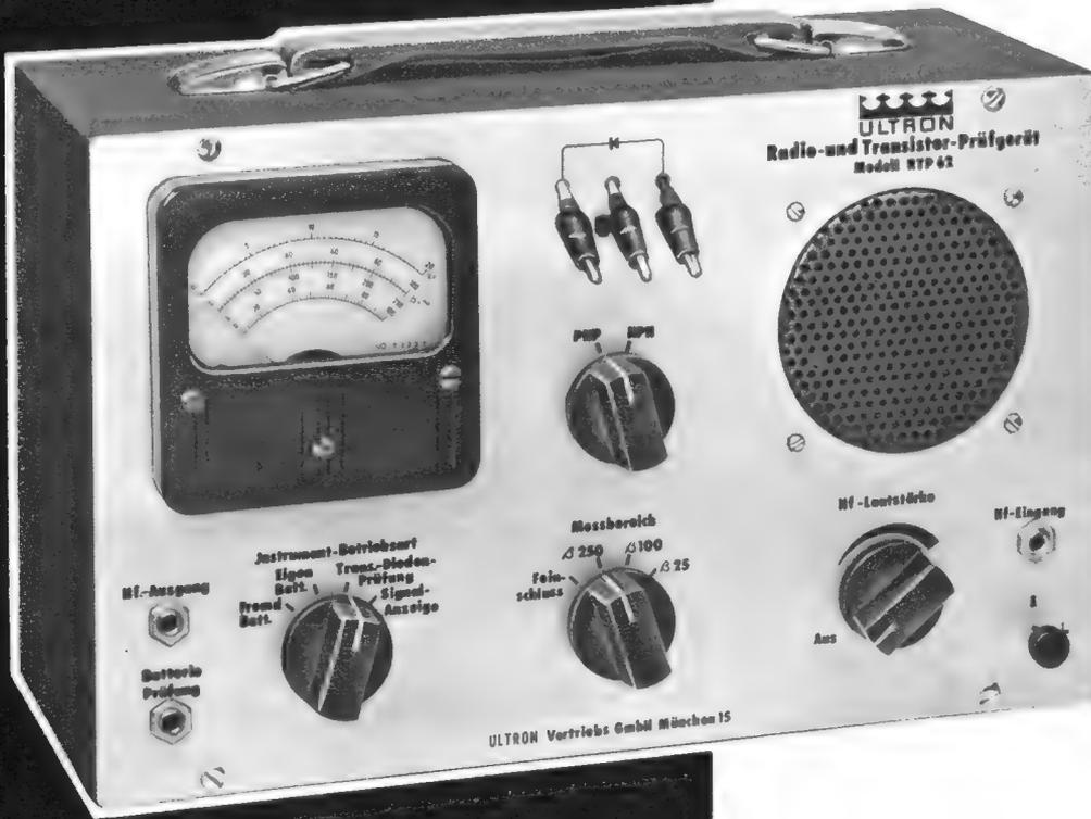
Das Gerät RTP 62 erlaubt nicht nur die Prüfung aller Empfängerstufen auf einwandfreie Funktion, sondern auch die Prüfung von Transistoren, Dioden und der Empfängerbatterie, so daß jeder normale Fehler ohne zusätzliche Meßgeräte in kurzer Zeit einzukreisen ist.
