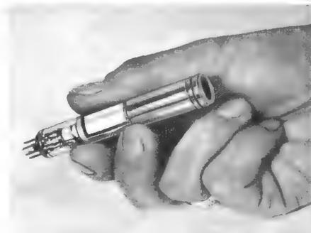
Bild 11. Ein Halbzoll-Vidikon Typ 9667 für Leichtgewicht-Fernsehkameras
