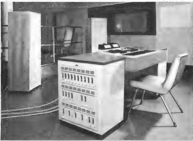
Bild 2. Zusammengebautes Stereo-Regiepult mit Stereo-Abhörlautsprechern
