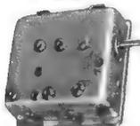
**UHF-Tuner**, mit den Röhren PC 86 und PC 88, ZF = 38,9 MHz, entspricht der allgemein bekannten Ausführung, für alle moderneren Empfängertypen. 43.-
